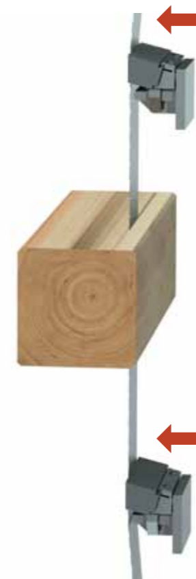
Verlauf der Schnittbahn mit passiver Druckführung
