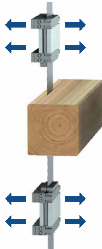
Verlauf der Schnittbahn mit aktiver Magnetführung (FBS-Technologie)
