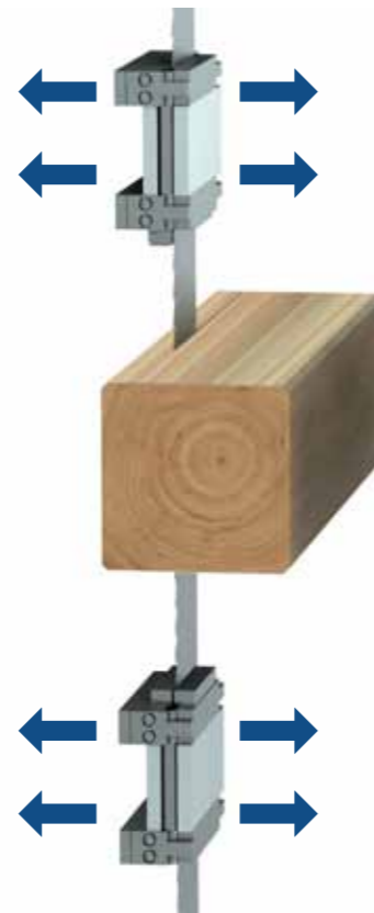
Verlauf der Schnittbahn mit aktiver Magnetführung (FBS-Technologie)
