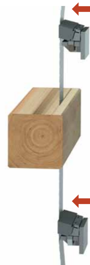
Verlauf der Schnittbahn mit passiver Druckführung
